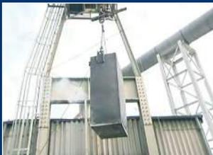
Danach wird der Tresor noch einmal 30 Minuten lang auf 840°C erhitzt, bevor er im Brandraum abkühlt.
