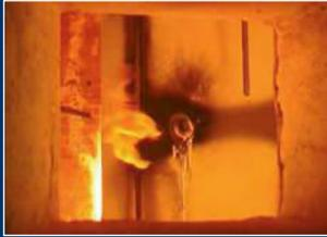
Im zweiten Teil, der Feuerstoß- und Sturzprüfung, wird der Tresor für 30 Minuten in einem zuvor bereits erhitzten Brandraum weiter auf 1090°C erhitzt.
